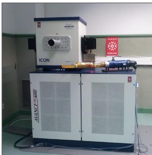
Figura 23. Equipo ICON-1T de bioimagen de la UCM. Es un equipo de Imagen de Resonancia Magnética (MRI) de bajo campo que permite la obtención de imágenes de resonancia magnética in vivo y ex vivo. El sistema ICON es un equipo de MRI compacto de alto rendimiento que permite al científico sin experiencia en imagen de resonancia acceder al potencial que tiene esta técnica y generar resultados de imagen cuantitativos para dar respuesta a cuestiones biológicas in vivo. La MRI es una técnica utilizada habitualmente en clínica, y por tanto, los resultados obtenidos con el mismo en rata y ratón son completamente escalables y traducibles al hombre ya que muchas aplicaciones clínicas, secuencias y enfoques de IRM-Clinico pueden realizarse en el ICON. Imagen tomada de
