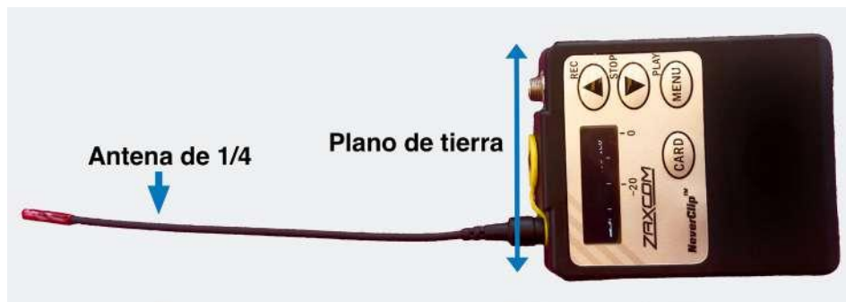
Ilustración 92. Transmisor con antena monopolo de 1/4.
