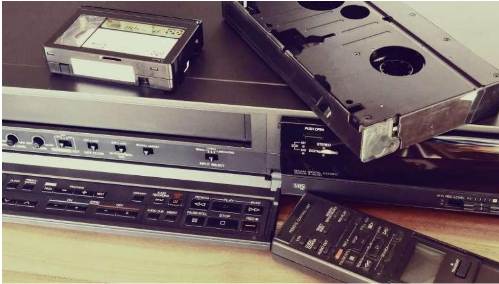
Ilustración 118. Magnetoscopio, mando a distancia, cinta de vídeo para cámara y cinta convencional en formato VHS.
