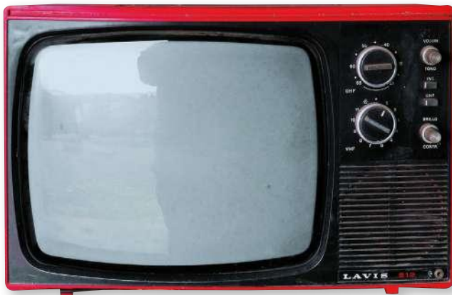
Ilustración 117. Aparato de televisión para dos canales (UHF y VHF) fabricado por Lavis en Barcelona.
