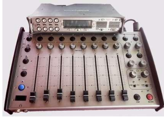
Ilustración 78. Grabador Sound Devices 788T con superficie de control CL9. 12 pistas.
