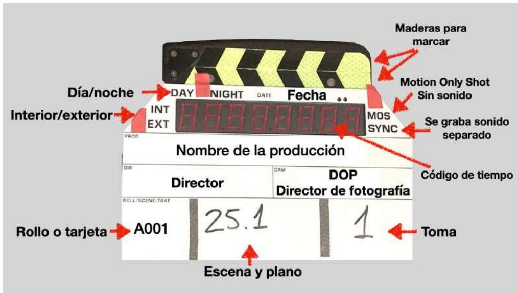
Ilustración 81. Una claqueta electrónica y la información que contiene.
