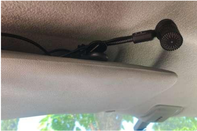
Ilustración 86. Micrófono plantado en el parasol de un coche.
