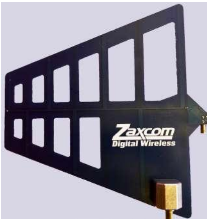
Ilustración 94. Antena LPDA con ranuras para ofrecer menos resistencia al viento.
