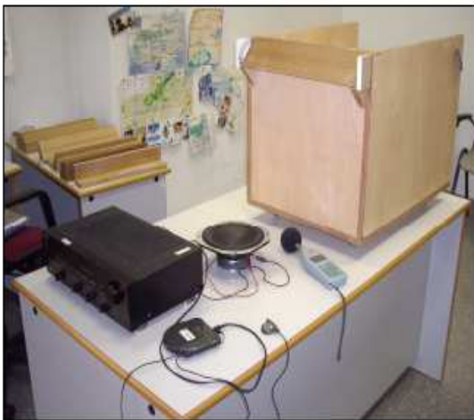
Figura 19: Emisor, sonómetro exterior y caja acústica
