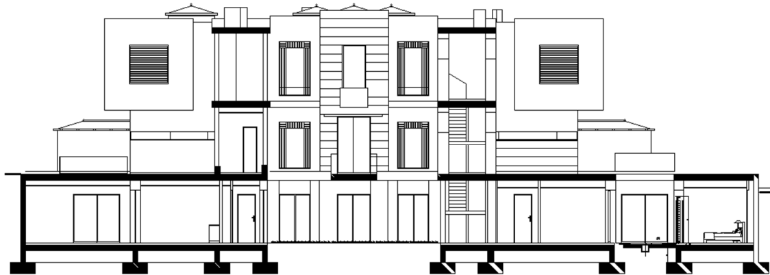
Figura nº34. Forjado sanitario de 0.6 m y 2m (Sección/Alzado Norte)
