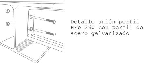
Detalle unión perfiles de acero galvanizado
