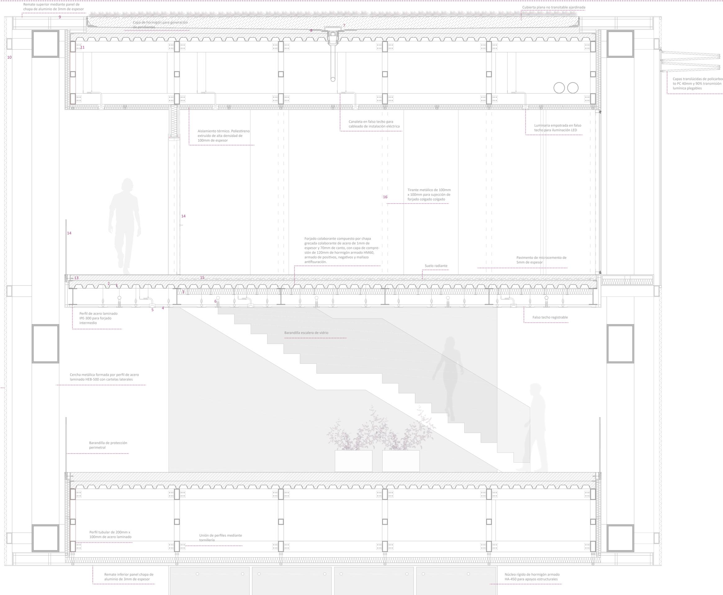
Capas translúcidas de policarbonato PC 40mm y 90% transmisión lumínica, machihembrable fijadas a perfil vertical mediante gancho.
